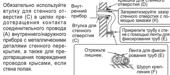
После проверки на отсутствие утечек плотно нанесите изоляционный материал, чтобы обеспечить отсутствие зазоров.
